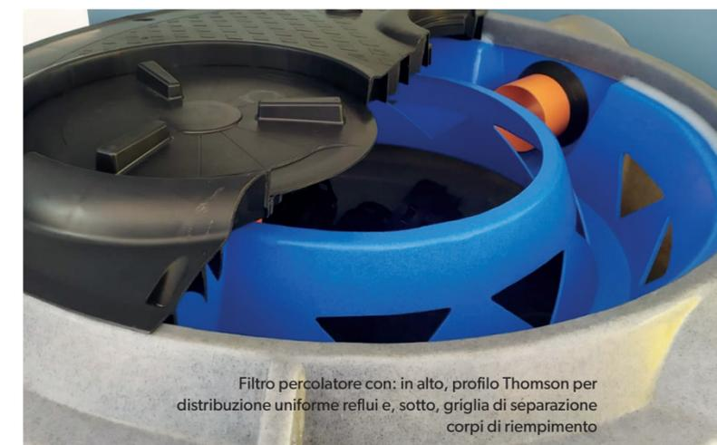
Filtro percolatore con: in alto, profilo Thomson per distribuzione uniforme reflui e, sotto, griglia di separazione corpi di riempimento
