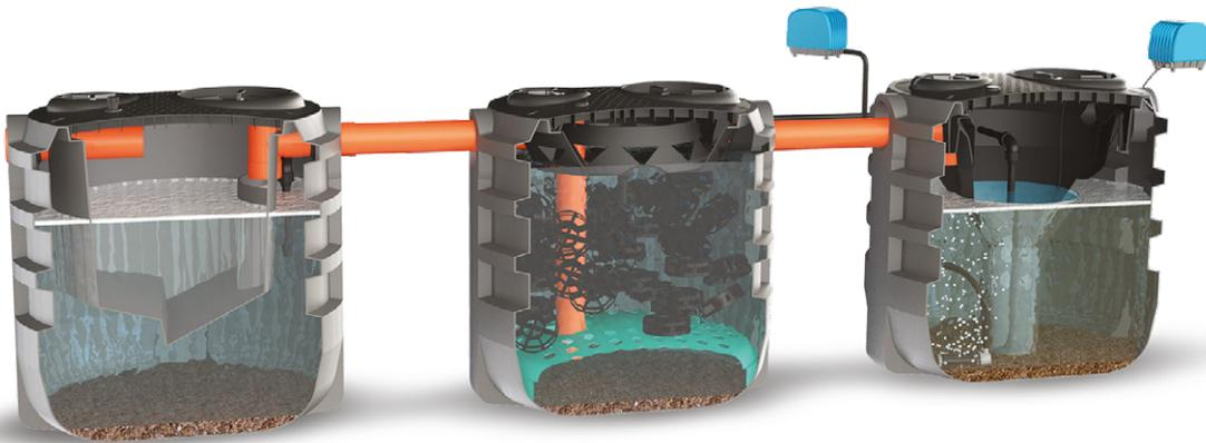
Sistema de depuración de alta eficacia para aguas residuales domésticas con posibilidad de reutilizar el efluente para el riego.
