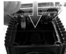
4 - Riposizionare nuova scheda e frontalino sul contaltri, prestando particolare attenzione ad alloggiare correttamente il cavo.
