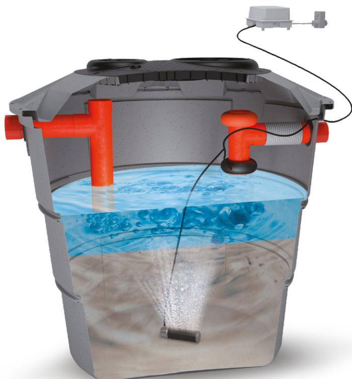
**Sistema biologico a fanghi attivi a biomassa sospesa di tipo sequenziale** (SBR: Sequencing Batch Reactor) per il trattamento dei reflui civili di piccole utenze (civili abitazioni, B&B, ecc.) che rende il refluo idoneo per lo scarico su suolo o il riutilizzo a scopi non potabili. Viene utilizzato a valle di degrassatori e deve ricevere solo reflui di scarico domestico evitando l'afflusso di acque parassite (scarichi meteorici, pluviali ecc.).
